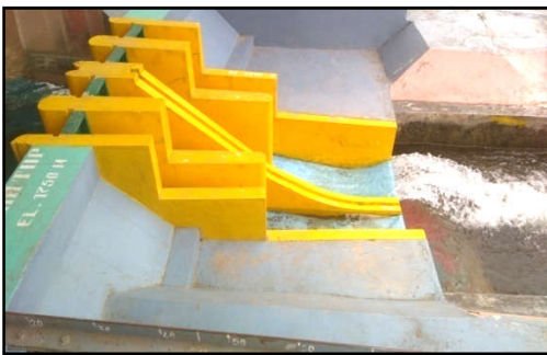
400 घन मी प्रति सेकंड निस्सारण के साथ अधिप्लव मार्ग के अनुप्रवाह पर, न्यूनतम जलाशय स्तर 1730.5 मी पर प्रवाह की स्थितियाँ (द्वार S1&S2 आंशिक प्रचालन करते हुए)
