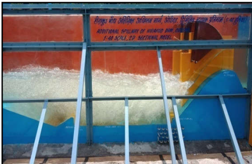
अधिप्लव मार्ग के द्वारिय प्रचालन के लिए अनुप्रवाह में प्रवाह स्थिति, 9,122 घन मी./से (100 %) के निस्सरण एवं जलाशय जलस्तर 191.45 मी. के लिए
