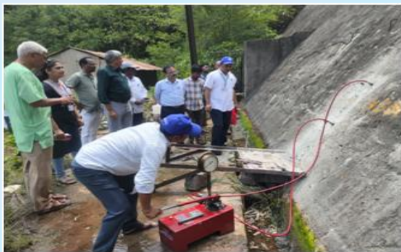
स्थान JH-3(R) पर फ्लैटजैक परीक्षण।
